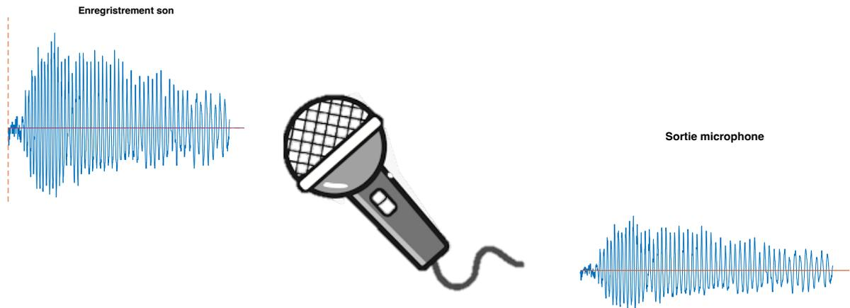
Figure 3. Microphone. Le graphique à l'entrée est la variation de la pression par rapport au temps. Le graphique à la sortie est identique en forme mais c'est un courant électrique généralement d'une faible amplitude.
